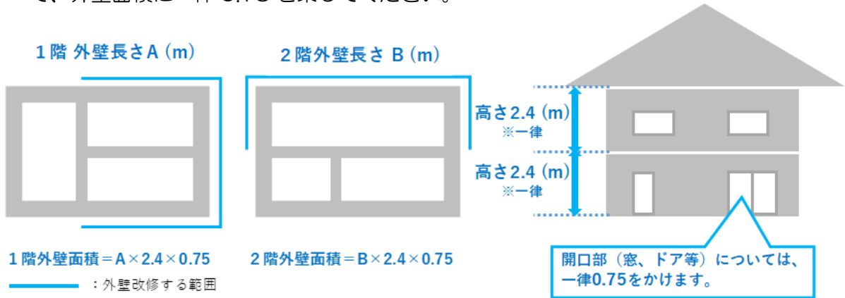
図7-1 外壁断熱改修
